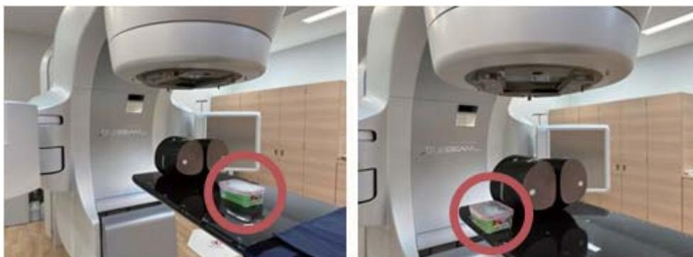
Fig.2 照射野外（左）に設置した場合と照射野内（右）に設置した場合
