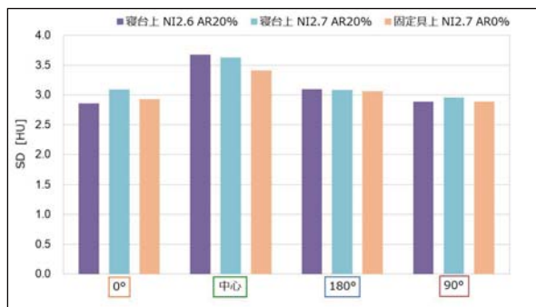
Fig.5 固定具上と寝台上での各位置における画像SD
