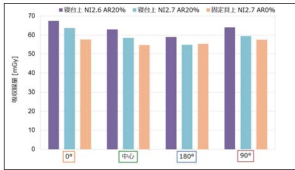
Fig.4 固定具上と寝台上での各位置における吸収線量
