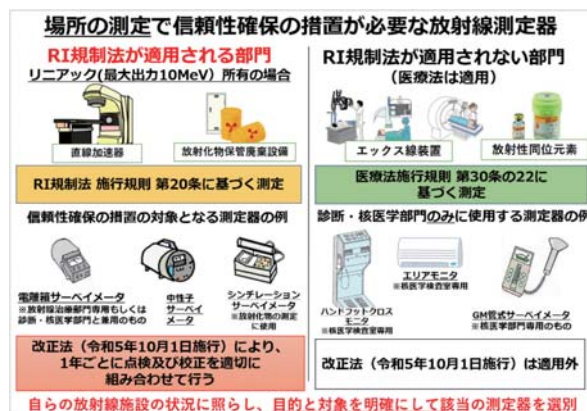
Fig.1 信頼性確保の措置の対象となる放射線測定器の例
