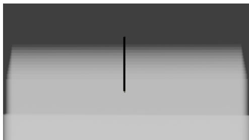
Fig.7 ダイナミックレンジ測定用ファントム像上のプロファイルライン
