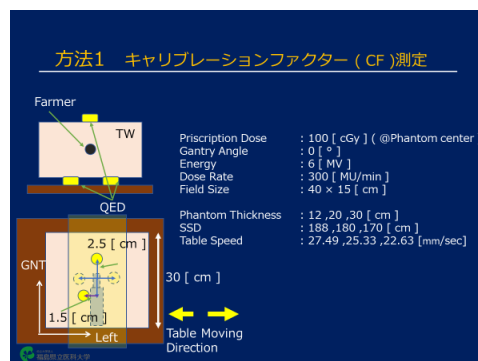
Fig.2 キャリブレーションファクター測定時のジオメトリと照射条件
