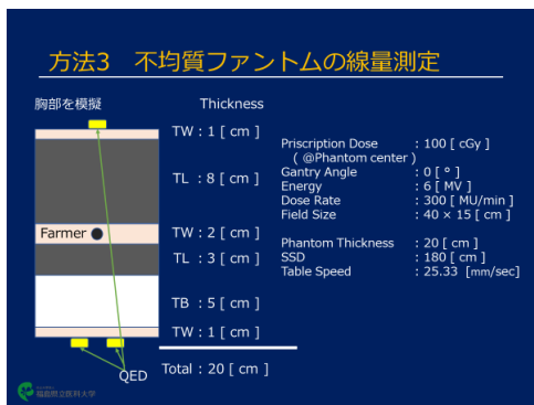
Fig.3 不均質ファントムの組成と照射条件
