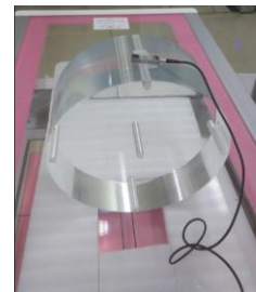
Fig.3 CTDI ファントム後方散乱測定
