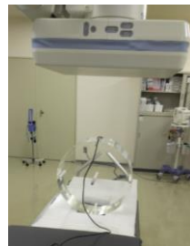
Fig.2 CTDI ファントム表面線量測定
