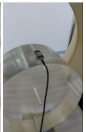
Fig.3 CTDI ファントム後方散乱測定
