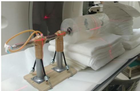
Fig.1 金属球発射台とドーナツ型ファントム
