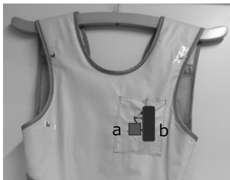
Fig.1 防護衣胸部に貼付した線量計の位置
