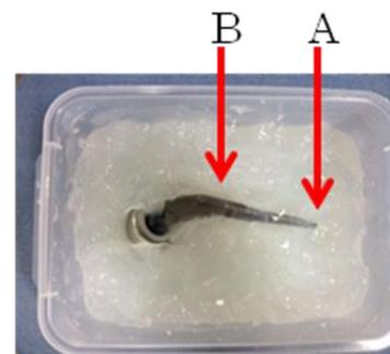
Fig.3 インプラント外観と測定点
