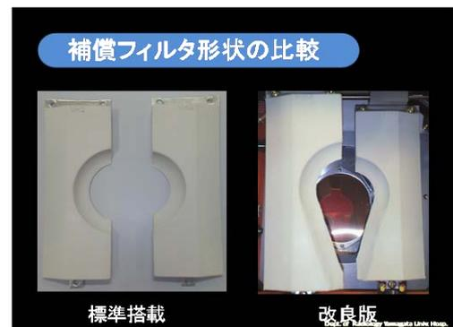
Fig.1 試作補償フィルタの形状比較
